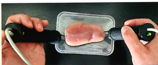
Figura 4. Disposición de los electrodos para la realización de una medida de bioimpedancia en un riñón de cerdo.
